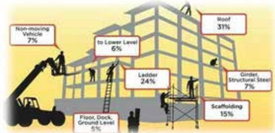
(سقوط از ارتفاع در قسمت‌های مختلف ساختمان)
